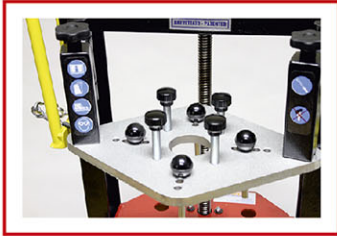
Piastra Universale per bloccaggio piattello Universal plate for blocking the upper cap
